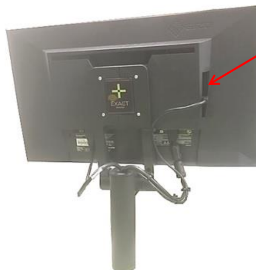
Afbeelding 8: USB-poorten op de achterkant van het beeldscherm (beschikbaar bij sommige ExactVu-systeemconfiguraties)
